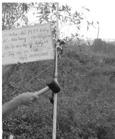
Hình 8.3. Kích thích dao động bằng búa cao su
