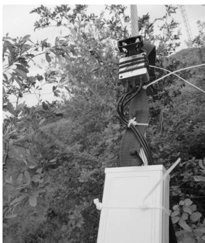
Hình 8.2. Gắn cố định cảm biến đo dao động lên bề mặt dây cáp
